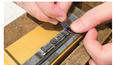
ブロックを組み合わせ隙間を埋めます
