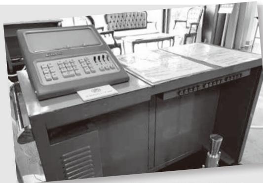
世界初の小型純電気式計算機「14-A」
